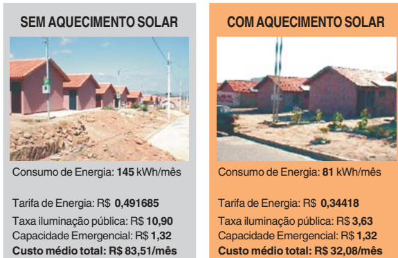
Figura 4: Comparativo das despesas com energia do Projeto Contagem Fonte: Green Solar – PUC/MG.
