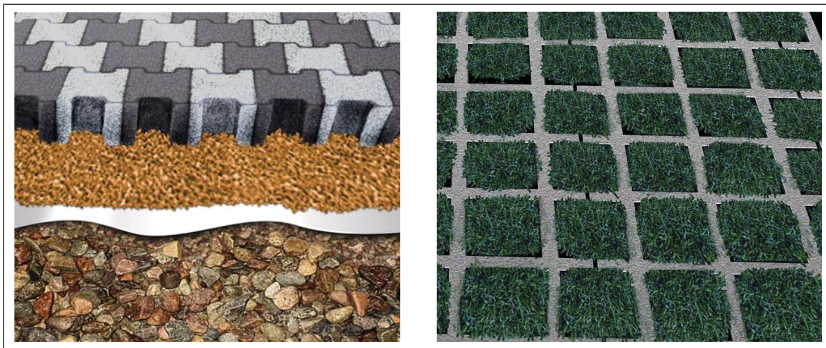
Figura 9: Pavimentos permeáveis. À esquerda pavimento com blocos de concreto permeáveis sobre camada de brita isolada por geotextil. À direita, “concregrama” apoiado sobre o solo.
