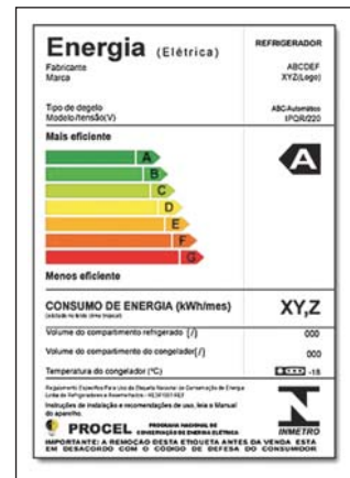
Figura 22: Exemplo de etiqueta de eficiência energética Nível A para refrigerador do Programa Brasileiro de Etiquetagem (Inmetro)
